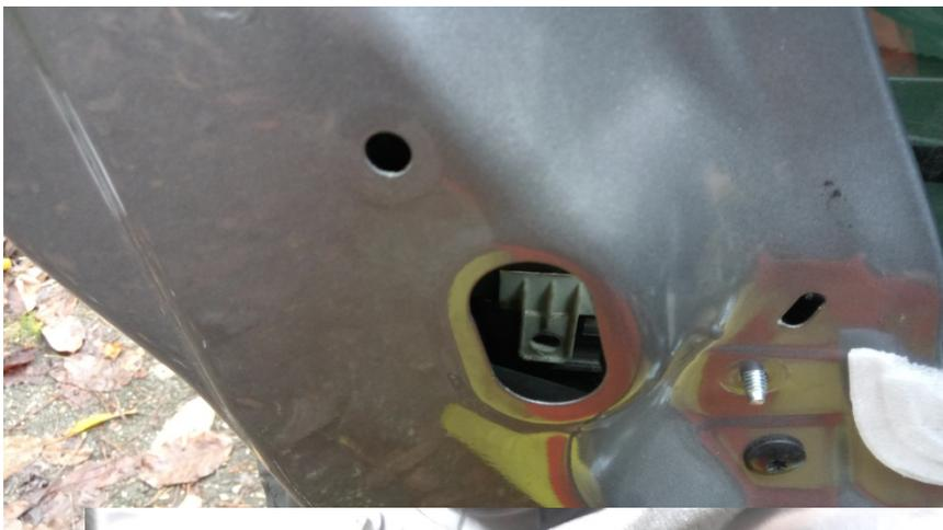
Die Türblende muss wieder mit dem Bedienpanel verbunden werden, danach wird die Scheibe in zwei unterschiedliche Positionen gefahren um die Scheibe demontieren zu können (2 Schrauben)
